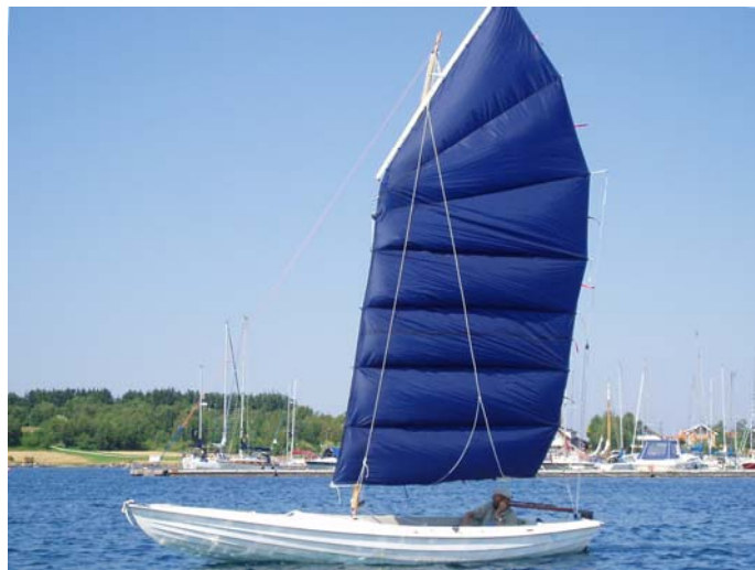
Mon dériveur Broreman avec une voile de 10 m 2 . Notez la balancine de mat et les lazy jacks simples.
